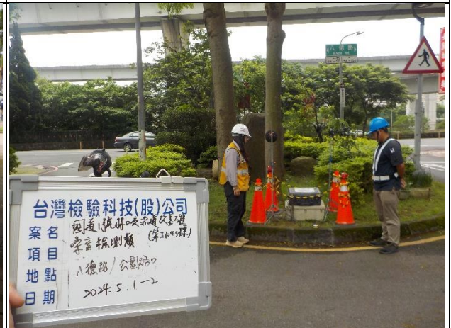
監測項目：環境噪音振動 監測日期：2024.05.01~02 監測地點：八德路/公園路口
