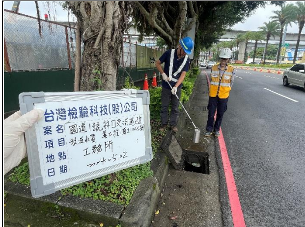
監測項目：放流水質 監測日期：2024.05.02 監測地點：工務所
